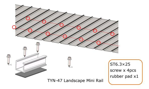
5.1.2 Fix the mini rail on the metal roof:
