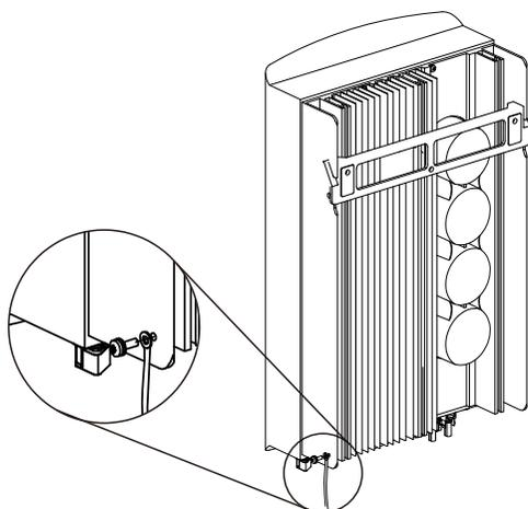
Figura 4.19 Collegare il conduttore di terra esterno
