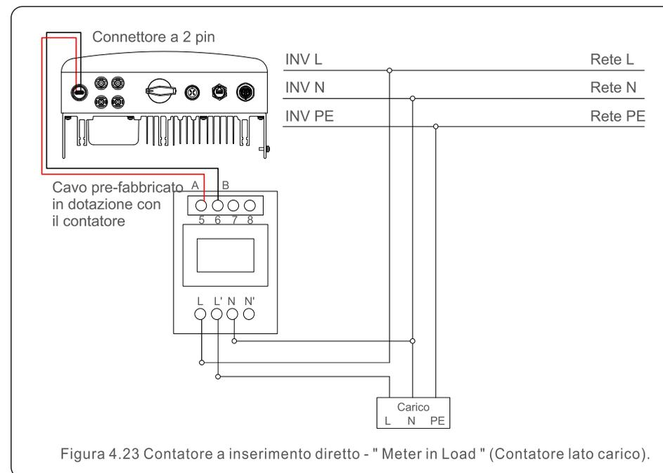
Figura 4.23 Contatore a inserimento diretto - "Meter in Load" (Contatore lato carico).
