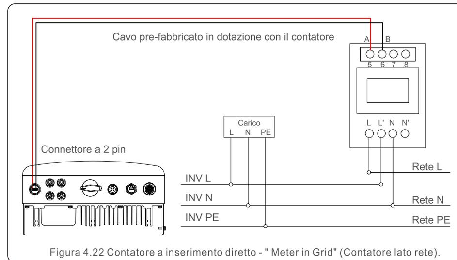
Figura 4.22 Contatore a inserimento diretto - "Meter in Grid" (Contatore lato rete).
