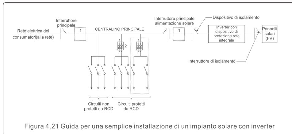
Figura 4.21 Guida per una semplice installazione di un impianto solare con inverter
