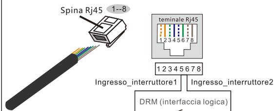
**Corrispondenza tra i cavi e i punti della spina, Pin5 e Pin6 del terminale RJ45 sono utilizzati per l'interfaccia logica, gli altri Pin sono riservati.**
