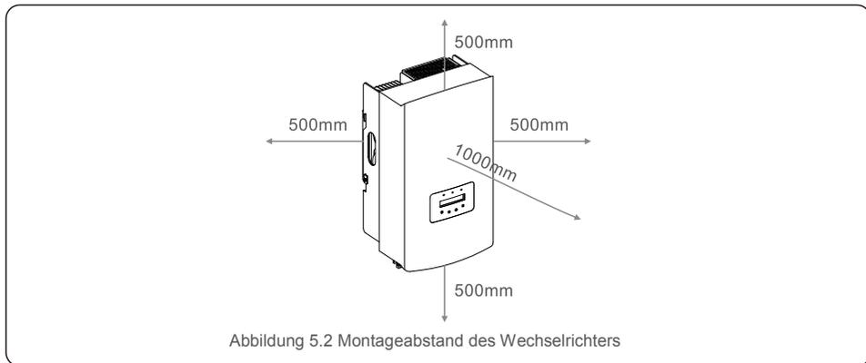
Abbildung 5.2 Montageabstand des Wechselrichters
