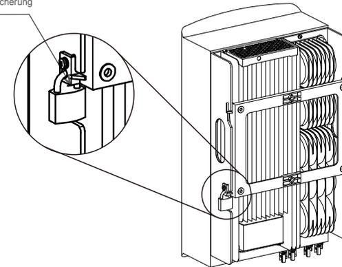
Abbildung 5.7 Sicherheitsschloss einbauen
