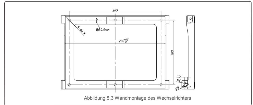
Abbildung 5.3 Wandmontage des Wechselrichters
