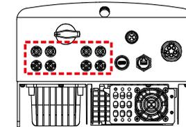
Abbildung 5.18 Verbindung des Gleichstromsteckers mit dem Wechselrichter
