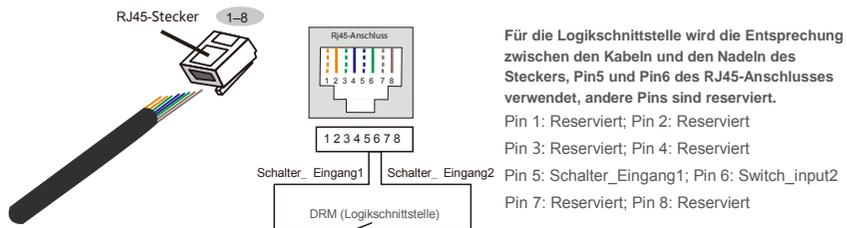
Abbildung 5.31 Abisolieren der Isolationsschicht und Anschluss an RJ45-Stecker
