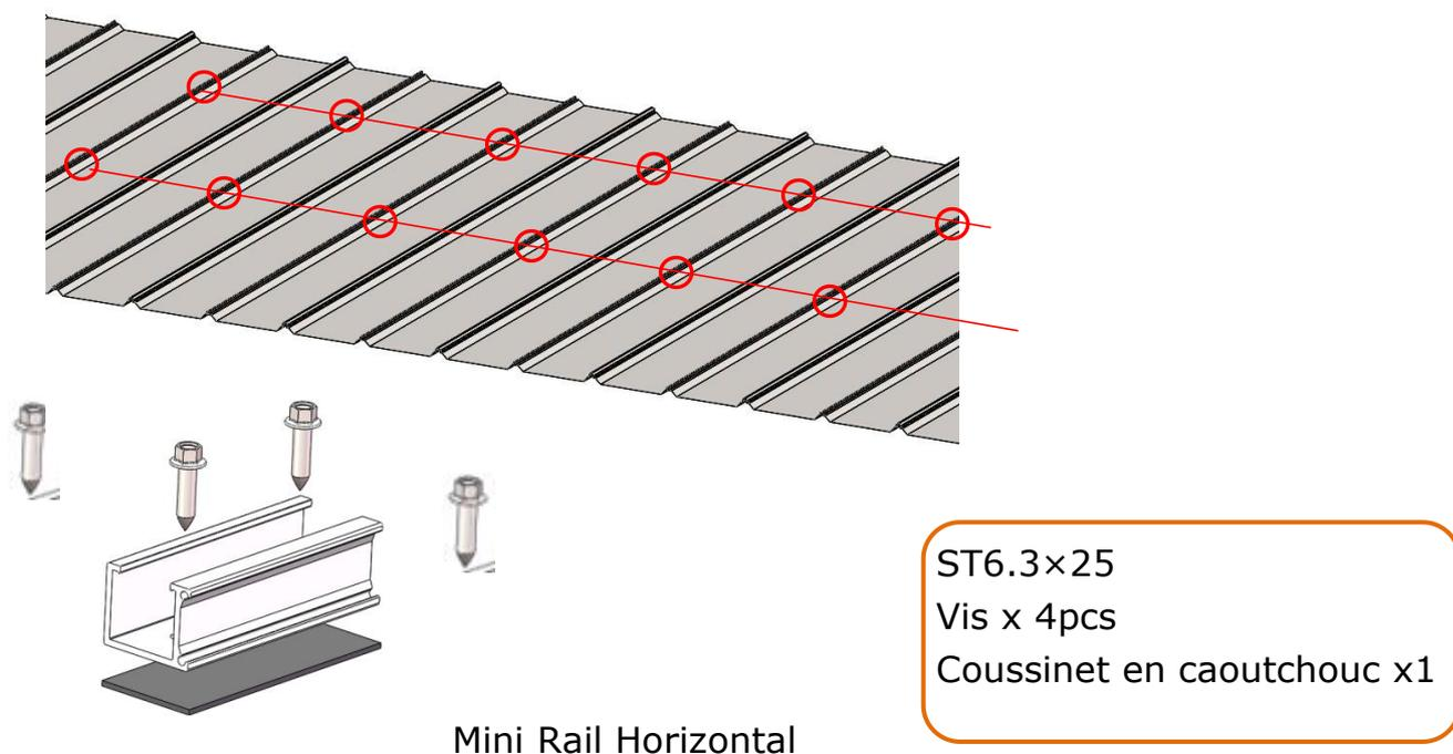
5.1.2 Fixez le mini rail sur le toit métallique :
