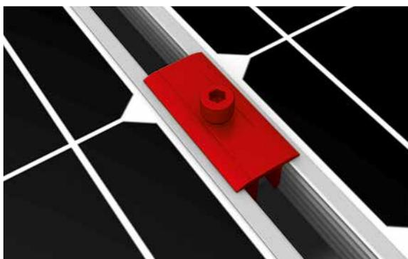
In caso si utilizzino morsetti intermedi standard, avvitarli ai tasselli con viti M8. Coppia di serraggio 16 Nm.
