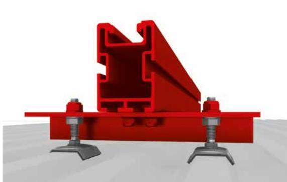
Per poter realizzare campate di maggiori dimensioni, al posto della piastra regolabile su due vite tirafondo è possibile montare l'elemento K2 Bridge. A seconda del tipo, il profilo viene fissato all'elemento Bridge con una o due viti a testa a martello M10x30.
