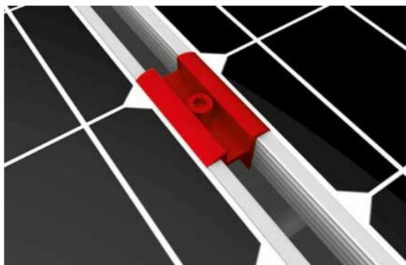
Usare due morsetti intermedi universali OneMid tra due moduli. Inserire ad incastro il morsetto nel profilo. Posizionare i morsetti in corrispondenza della cornice del modulo e serrare. Coppia di serraggio 16 Nm
