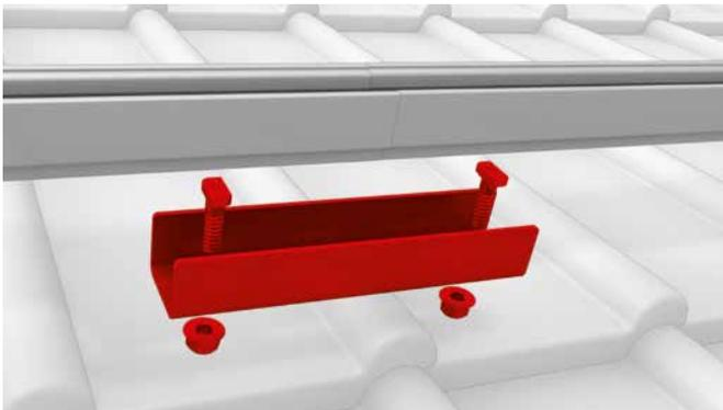
Posizionare i profili di montaggio a contatto uno con l'altro e con l'ausilio del congiuntore collegare le viti testa a martello. Il giunto del profilo non deve trovarsi in corrispondenza del gancio.
