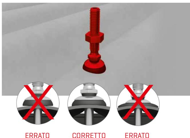
**Ulteriori informazioni:** La vite di fissaggio solare deve essere avvitata in modo tale che la guarnizione deve essere leggermente compressa e completamente a contatto con la superficie.
