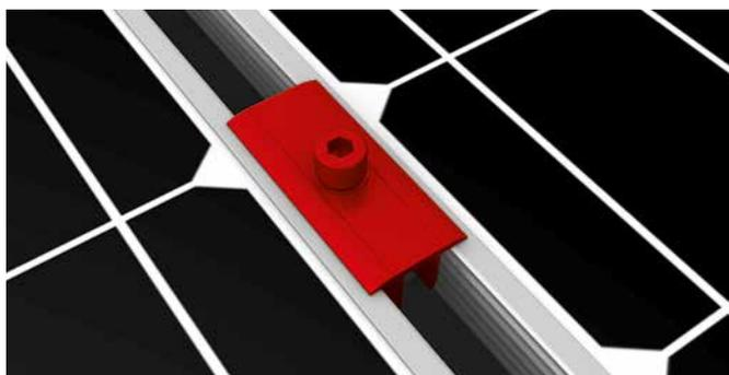
In caso si utilizzino morsetti intermedi standard, avvitarli ai tasselli con viti M8. Coppia di serraggio 16 Nm.
