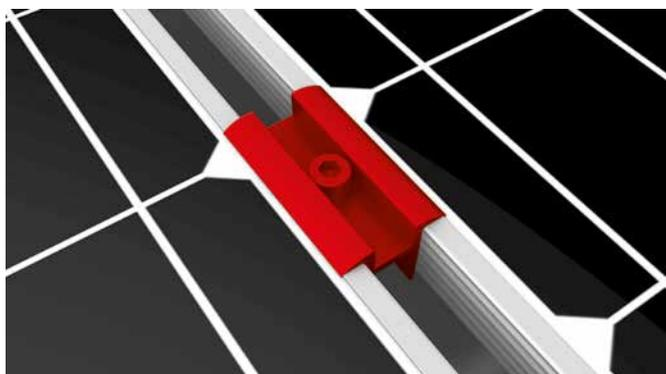
Usare due morsetti intermedi universali OneMid tra due moduli. Inserire ad incastro il morsetto nel profilo. Posizionare i morsetti in corrispondenza della cornice del modulo e serrare. Coppia di serraggio 16 Nm
