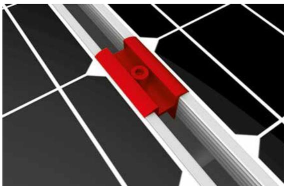
Usare due morsetti intermedi universali K2 Clamp/One-Mid tra due moduli. Inserire ad incastro il morsetto nel profilo. Posizionare i morsetti in corrispondenza della cornice del modulo e serrare. Coppia di serraggio 16 Nm
