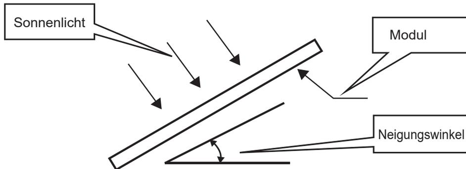
Es wird bevorzugt, dass Module auf der Nordhalbkugel nach Süden und auf der Südhalbkugel nach Norden ausgerichtet sind.
