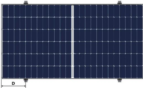
Installation eines gerahmten Moduls mit Befestigungen
