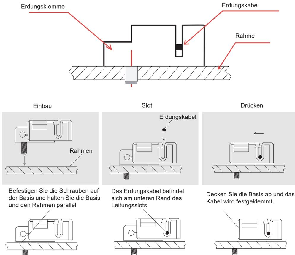
Abbildung 11 Installationsmethode der Erdungsklemme
