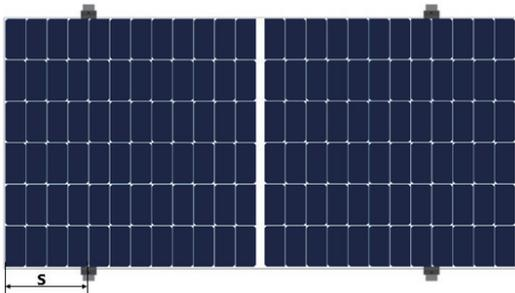
Installation eines gerahmten Moduls mit Befestigungen
